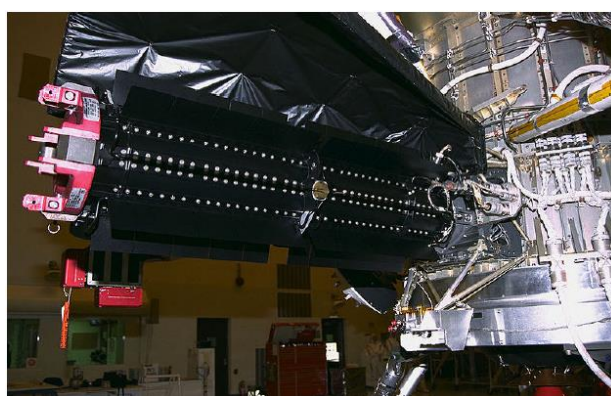
Figura 2.15 – Termogeradores na Sonda Voyager Fonte: Ando Júnior, 2014.
