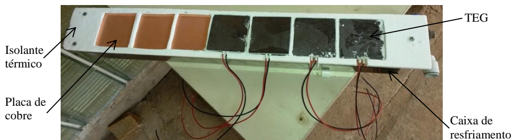
Figura 4.12 – Montagem dos TEG na caixa de resfriamento
